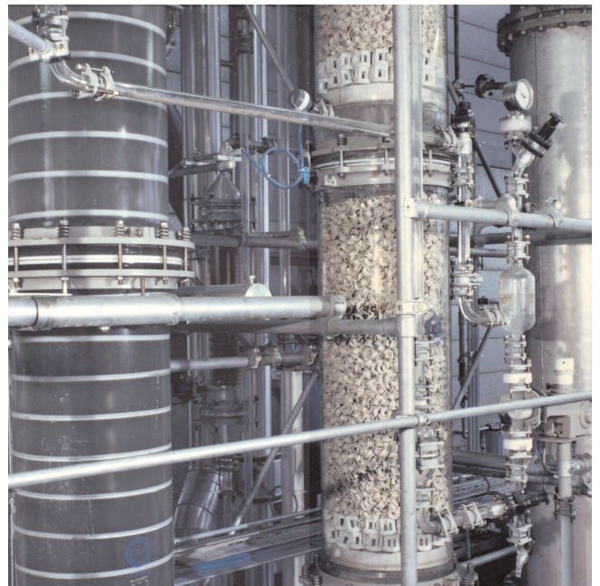
Abb. 1: QVF ® -Siebbodenextraktionskolonne und Rektifikation DN450
