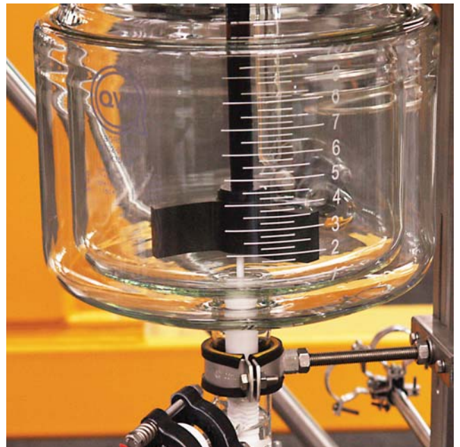
Abb.2: Bodenablassventil mit Thermometer, im Doppelmantelgefäß
